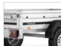
Profilerede sider for en mere stabil trailer.
