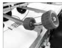
Dobbelte multijusterbare Premium X-line sideruller
