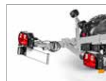
Separate lygtekonsol- ler. Lygterne drejes let til siden for søsætning og optagning
