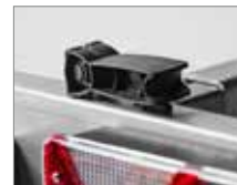
Lygtebom med kliklukketøj for let og hurtig montering og demontering
