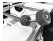
Dobbelte multijusterbare Premium X-line sideruller
